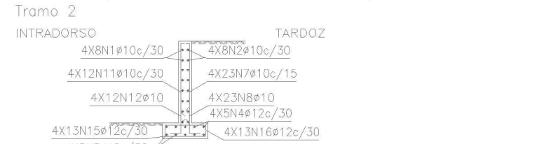
Corte Tramo 2- Armadura Alas e sapatas
